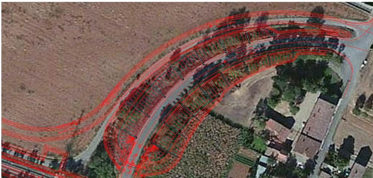
Proseguendo lungo la linea, al fine di ottimizzare l'accesso alla linea da parte dei mezzi di servizio, al Km 46+130 è stato inserito un accesso alla viabilità di servizio della linea sul lato del binario pari.
