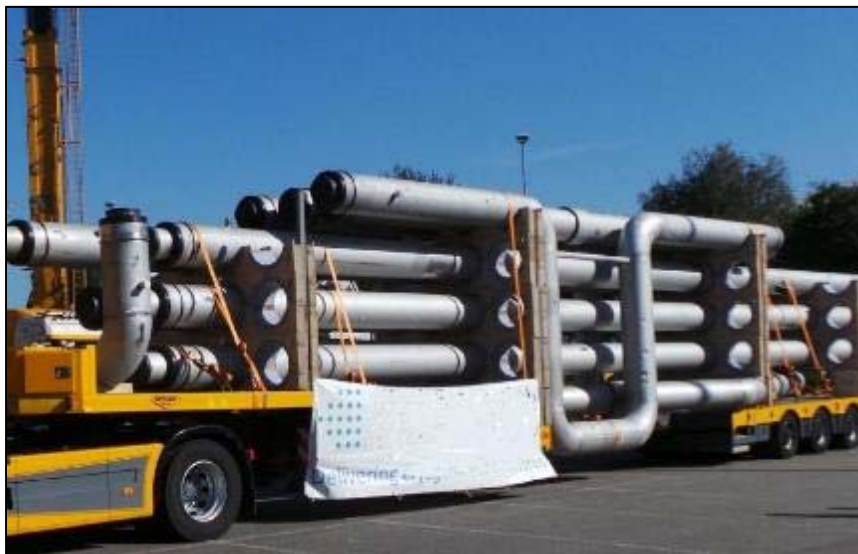
Figura 10: Loops di espansione per le tubazioni VIP
