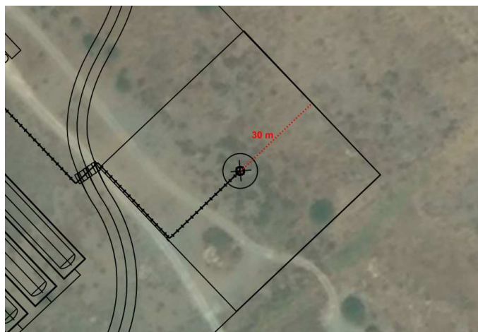
Figura 3 - Dettaglio ubicazione torcia di terminal
