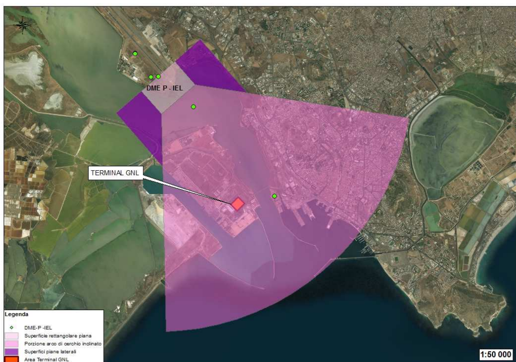
Figura 27 - BRA relative all'apparato direzionale DME P-IEL (apparato di misurazione della distanza)
