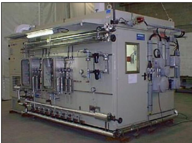
Figura 21: Skid Sistema di analisi – Cabina cromatografi
