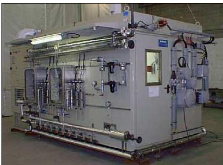
Figura 18 - Skid Sistema di analisi – Cabina cromatografi
