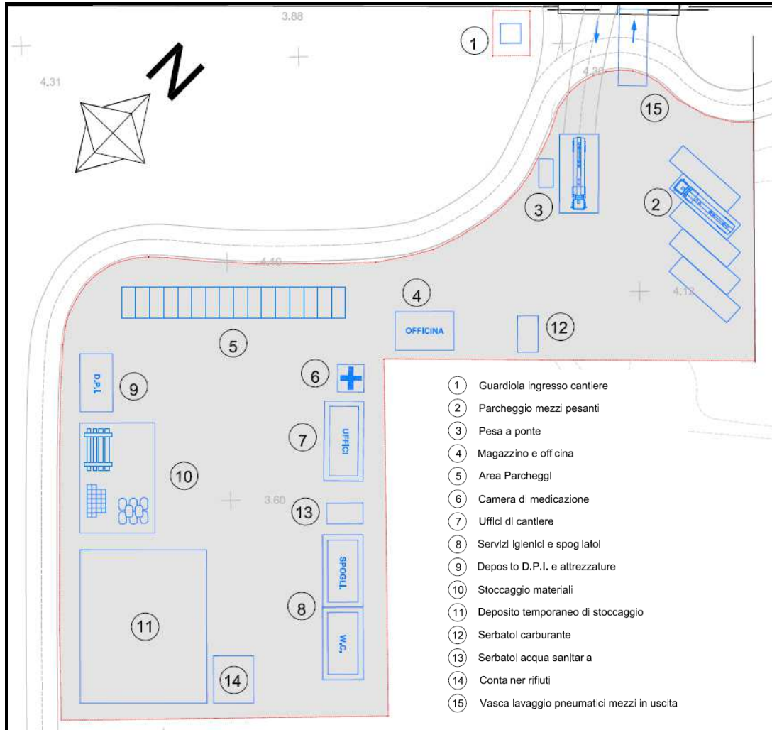
Figura 36 – Area di cantiere e suddivisione aree logistiche.
