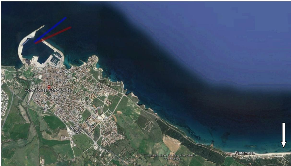
**Figura 4 in BLU rotta di accesso attuale 50°N, in ROSSO rotta di accesso di progetto 66,25°N. Ad est Platamona ad una distanza di oltre 5Km.**
