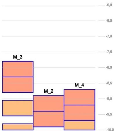
\* La quota dei sedimenti marini sotto la banchina esistente è stata ipotizzata per interpolazione e sulla base del progetto preliminare. Da verificare sulla base dei nuovi sondaggi da effettuare.
