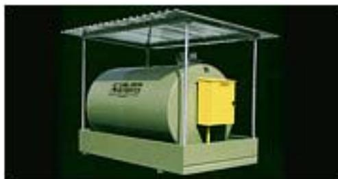
Raccogliere i carburanti in distributori mobili omologati, di capacità non superiore a 9000 litri, (*immagine punto 9.3.1.*) dotati di idoneo bacino di contenimento e tettoia non combustibili e provvisti di messa a terra, verificando la presenza del tappo sul fondo del bacino stesso. Stoccare le bombole di GPL in appositi depositi, non interrati e ben ventilati, distinte tra piene e vuote e fissate in posizione retta. Non esporre le bombole a urti e cadute.
