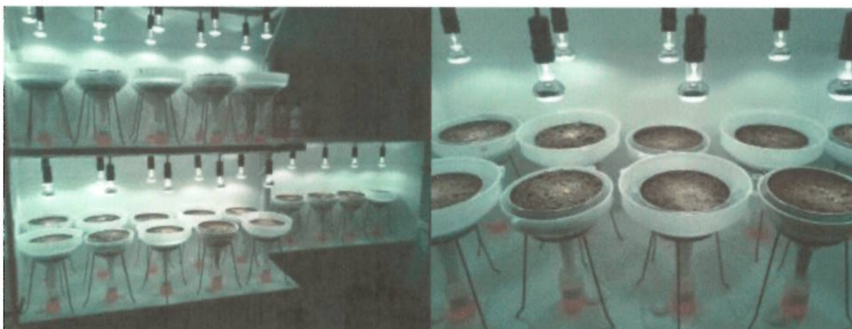
Figura 5. La batteria di estrattori di Berlese-Tullgren utilizzata in laboratorio per l'estrazione dei microartropodi dal suolo, con particolare dei campioni di suolo preparati per l'estrazione.
