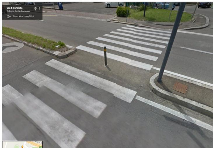
In corrispondenza dell'interruzione dello spartitraffico esistente la larghezza dell'isola centrale a protezione dell'attraversamento pedonale (vedi figura) corrisponde alla larghezza minima di 1.20 m prevista nel Regolamento Viario per le isole salvagente (vedi art. 21.2.11.2). Inoltre l'allargamento dello spartitraffico porterebbe ad una riduzione della carreggiata che non consentirebbe più l'attuale transito veicolare a due corsie.
