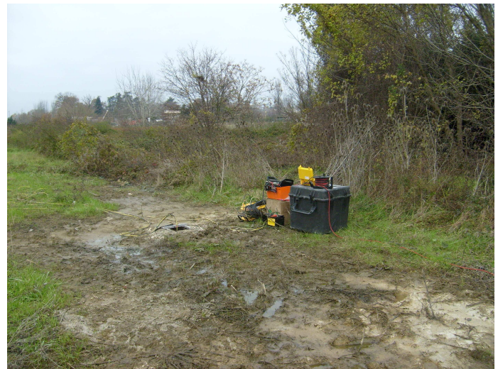
Postazione foro OC3S2bis con geofono e sismografo
