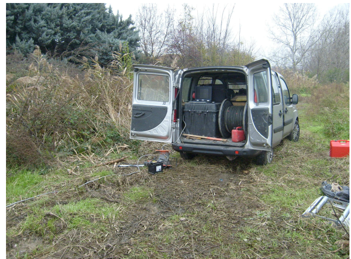
Postazione per misura di verticalità
