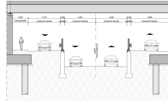
SEZIONE TIPO SU OPERA STATO DI PROGETTO – scala 1:100
