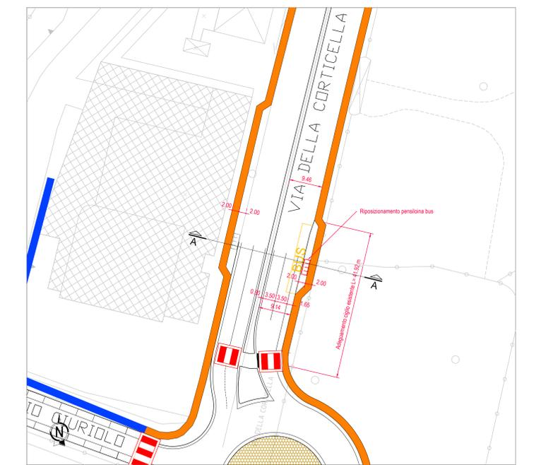
DETTAGLIO 1 - SCALA 1:500 - RIPOSIZIONAMENTO PENSILINA BUS
