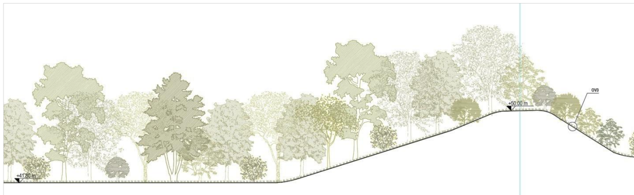
Figura 19 - Rilevato realizzato con materiale inerte, rivestito con terreno vegetale e piantumato, con l'obiettivo di mitigare gli impatti visivi e acustici derivanti dalla realizzazione della nova infrastruttura.
