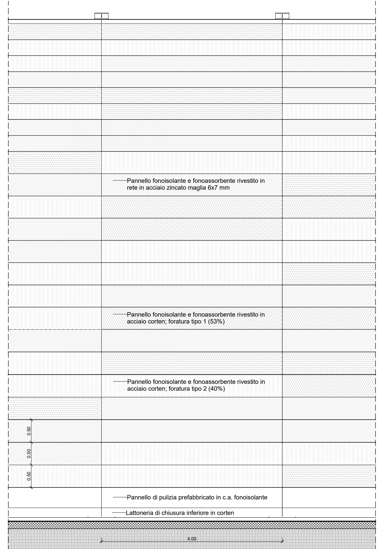
2 | Prospetto lato tangenziale/autostrada Scala 1 : 50
