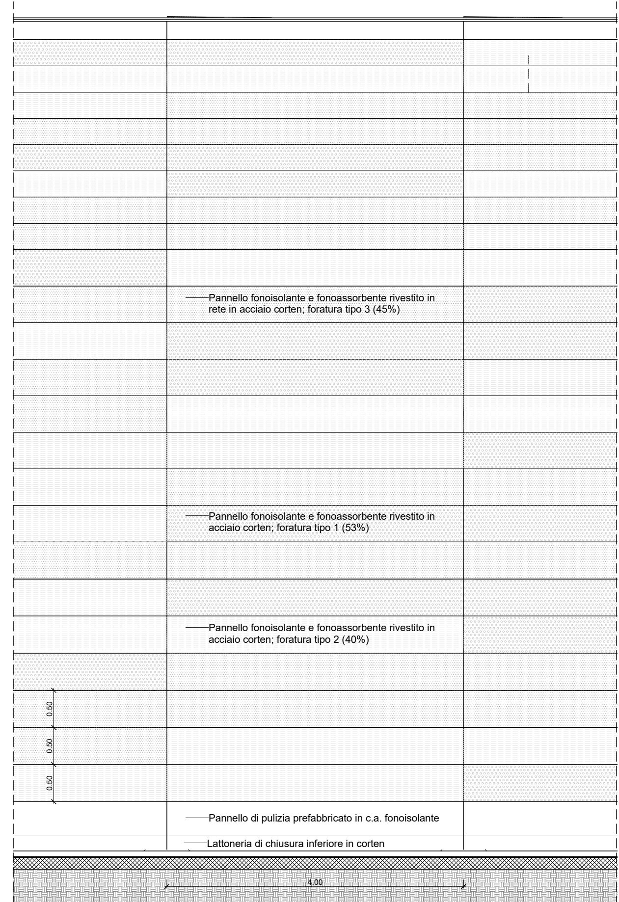
2 Prospetto lato tangenziale/autostrada Scala 1 : 50
