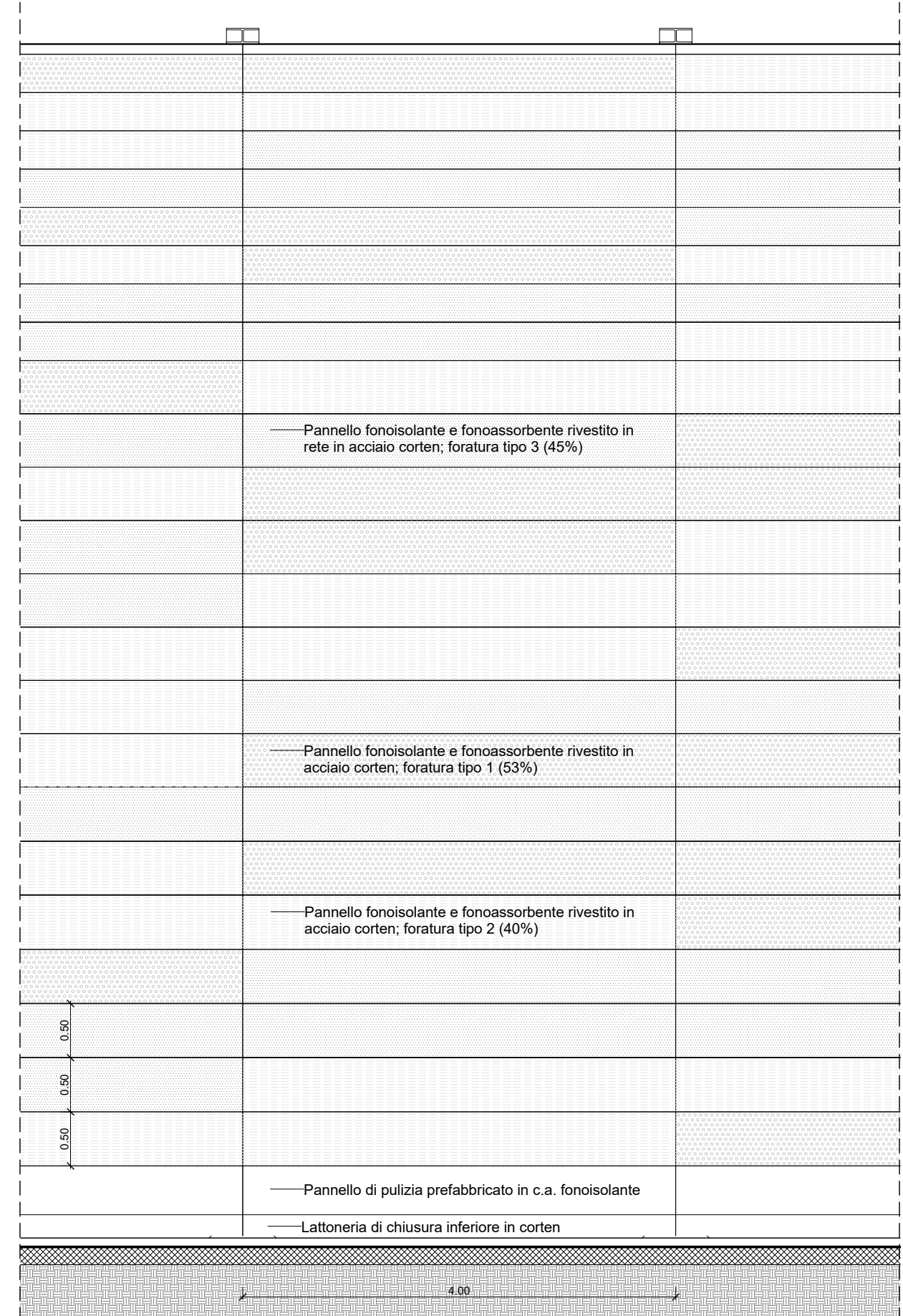
2 | Prospetto lato tangenziale/autostrada Scala 1 : 50
