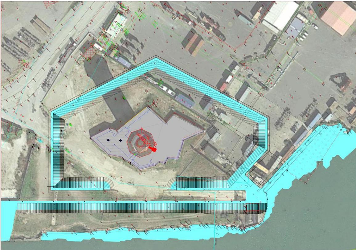
Tale struttura permetterà di effettuare lo scavo del canale intorno alla Torre e successivamente, dopo gli interventi di restauro e risanamento conservativo sulla fortificazione settecentesca e sulla Torre sopra meglio descritti, di completare lo scavo attorno alla Torre al fine di completare il ripristino dell'acqua attorno alla Torre quattrocentesca.
