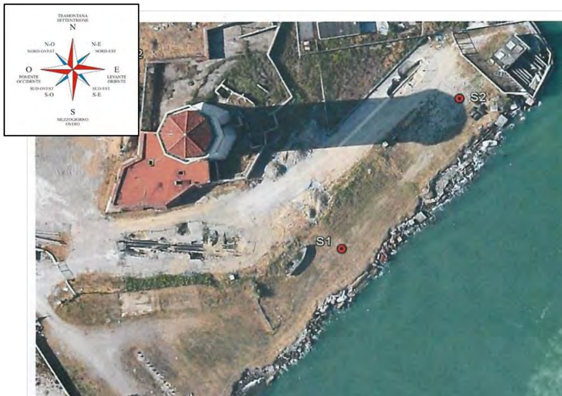
Figura 8 – Ubicazione sondaggi profondi interni all'area A4
