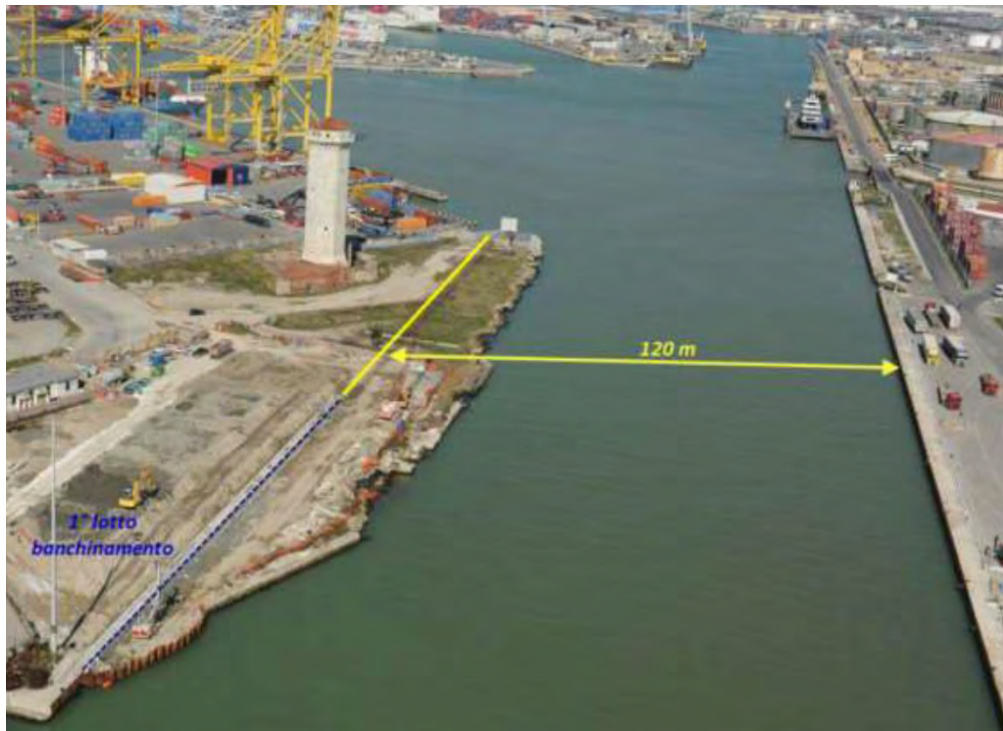
Figura 16 – Indicazione del riprofilamento del secondo lotto (in giallo) previsto dal progetto
