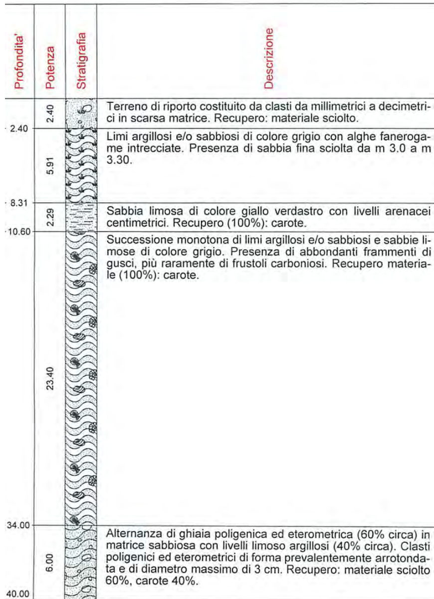
Figura 10 - Stratigrafia relativa al sondaggio integrativo S2
