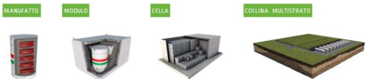
Figura 3.3-6: Le barriere ingegneristiche del Deposito Nazionale
