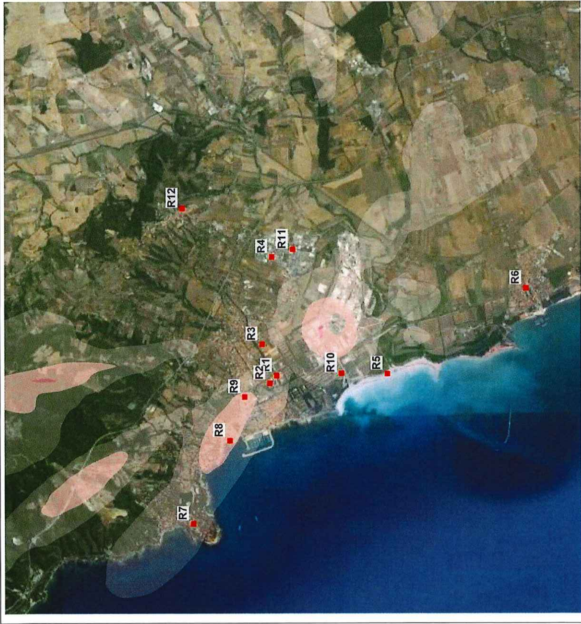
Tavola 4b - Concentrazioni massime orarie di CO – scenario B di progetto (TG1)
