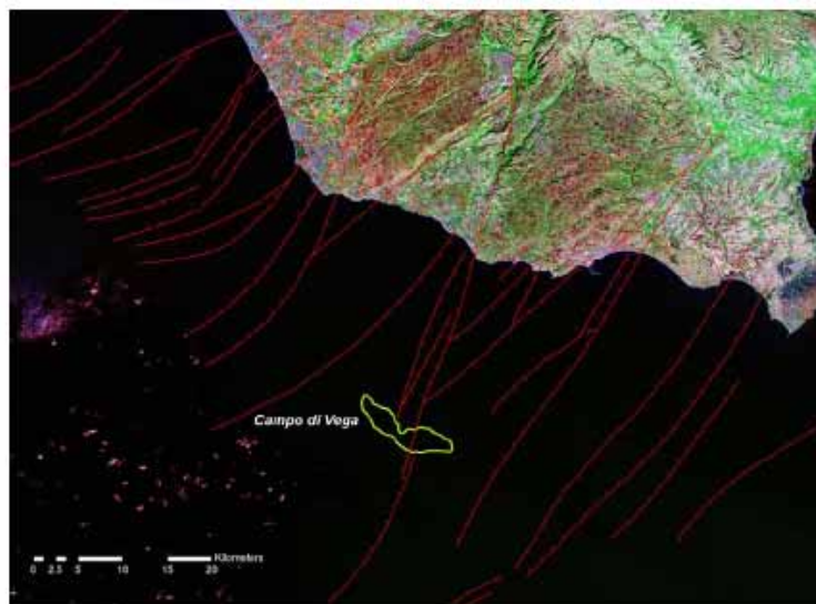
Figura 16: Schizzo tettonico della Sicilia sud occidentale con l'indicazione delle faglie maggiori identificate al top della Fm Ragusa (Miocene Inferiore) (faglie tratte da Grasso et al. 2000, Carta Geologica degli Iblei Centro-Meridionali). La Linea di Scicli è la struttura che divide in due il Campo di Vega.
