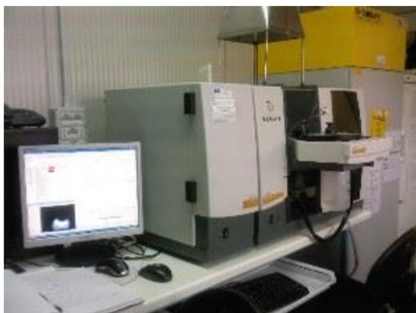
**A2-IX      VARIAN ICP-720ES per la misurazione di ALLUMINIO, BARIO, FERRO, CROMO, NICHEL, RAME, SILICIO, VANADIO e ZINCO**
