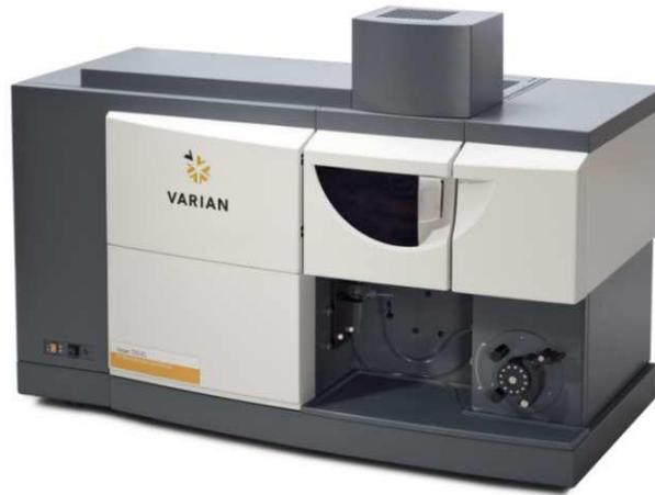
Spettrofotometro ad emissione atomica al plasma ad accoppiamento induttivo (ICP) e lettura sequenziale. Il sistema di raccolta della radiazione emessa dal plasma è di tipo assiale. Il generatore di radiofrequenze è 40 MHz. Per il raffreddamento del plasma viene impiegato argon ultrapuro.
