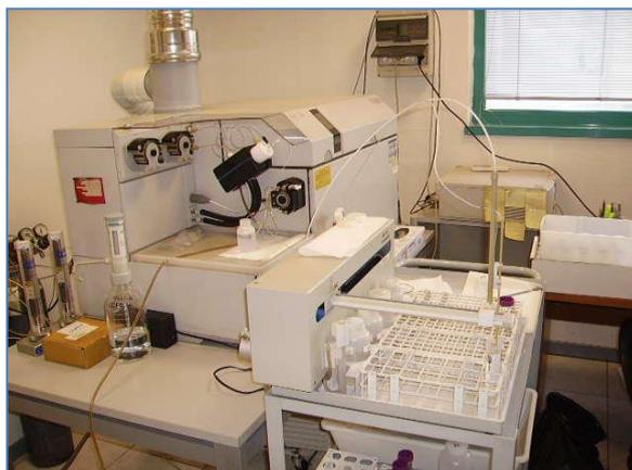
**A1- VII Analisi del Silicio - Spettrofotometro a emissione atomica
