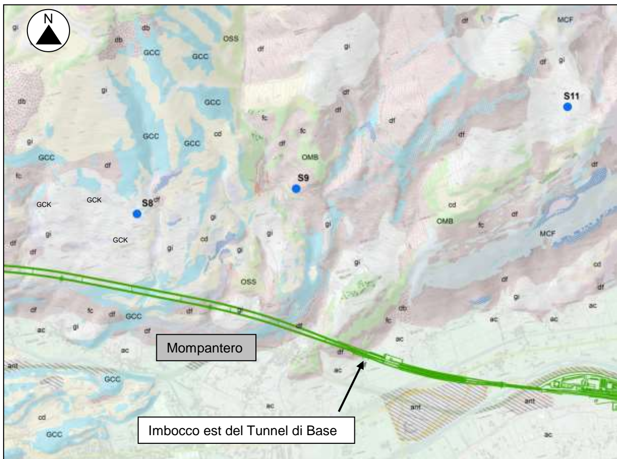
Figura 1 – Ubicazione dei sondaggi considerati per la valutazione delle concentrazioni in amianto negli ammassi rocciosi nella zona dell'imbocco est del Tunnel di Base.
