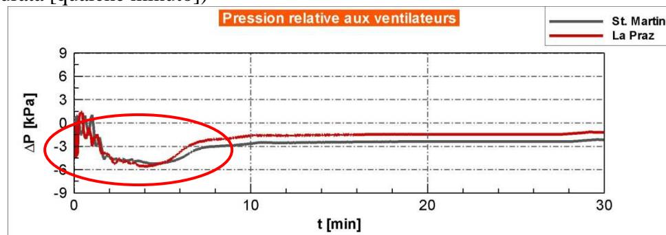
Dimensionare i ventilatori per il solo regime stabile è limitante : i ventilatori si troverebbero a lavorare nella zona di pompaggio per diversi minuti, con in conseguente rischio di rottura meccanica. In aggiunta gli obiettivi di di velocità d'aria in tunnel non potrebbero essere raggiunti.
