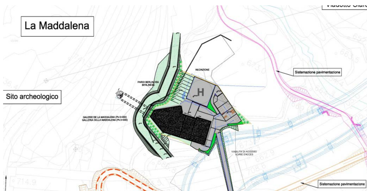
Figura 1: Centrale di ventilazione di Maddalena e elisuperficie da Progetto Definitivo Approvato
