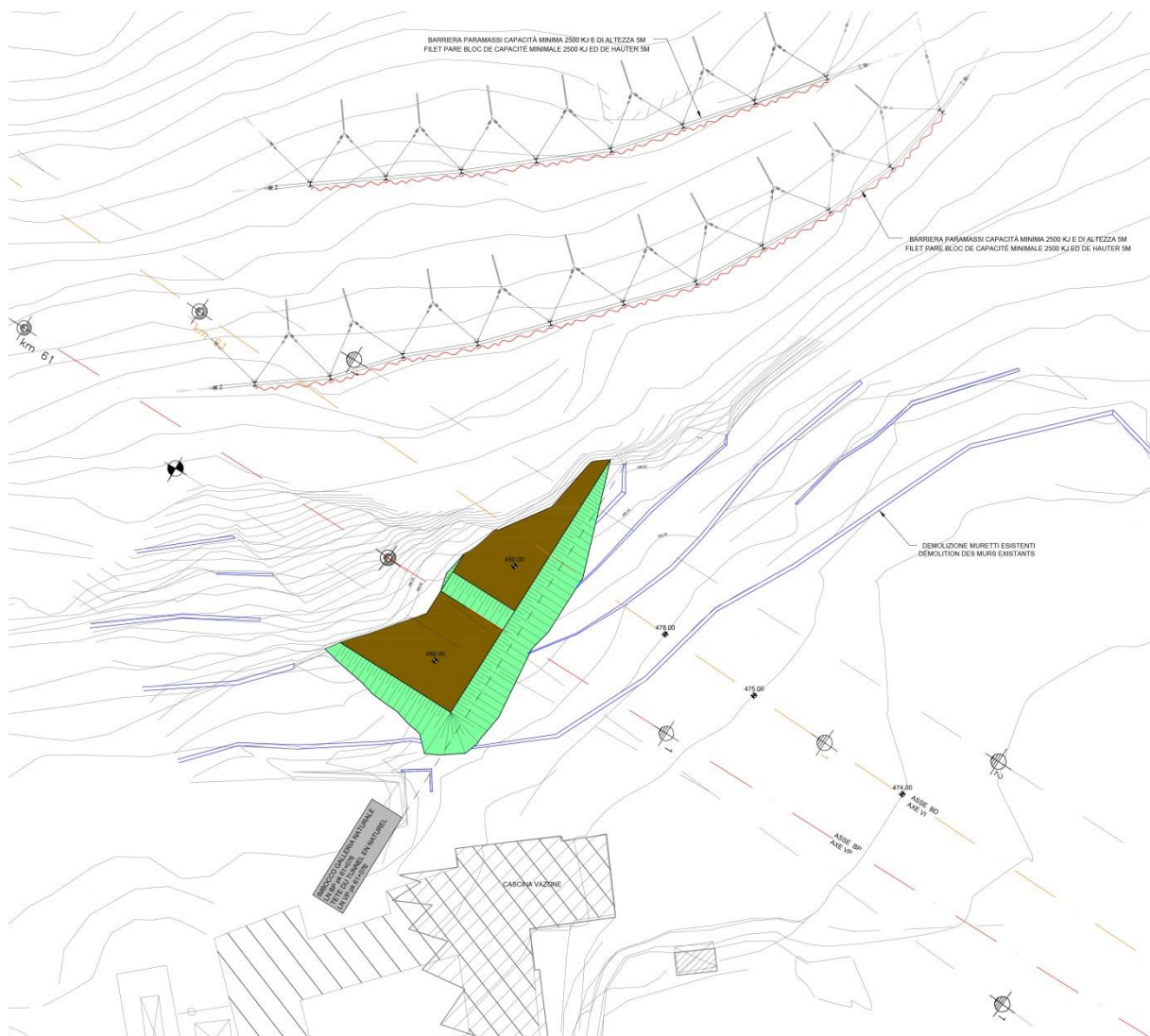
Figura 2 – Area di imbocco durante la fase 1 di cantiere
