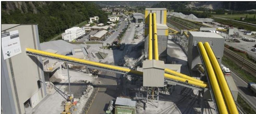
**Figura 24** – Cantiere AlpTransit (Pollegio) – Movimentazione dei materiali provenienti dagli scavi e degli aggregati mediante nastri trasportatori (si possono anche osservare sulla sinistra l'impianto di valorizzazione, al centro i silos di stoccaggio degli aggregati e sulla destra la centrale di betonaggio)
