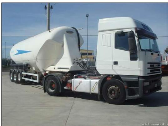
*Figura 16 – Camion cisterna per trasporto del cemento*
