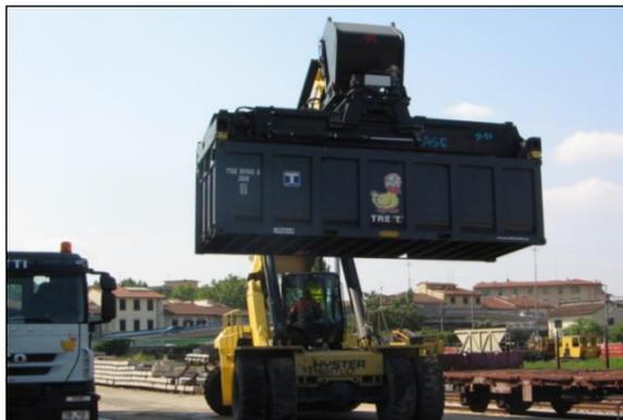
*Figura 22 – Nodo di Firenze – Caricamento dei container mediante staker*
