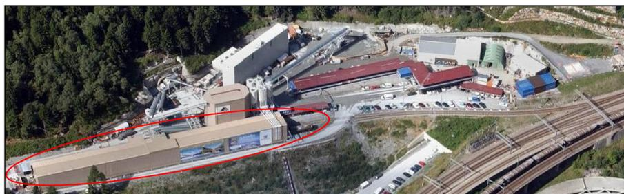
*Figura 23 – Cantiere del Loetschberg – Impianto di caricamento con tramogge distribuite lungo l'intero fascio binari*
