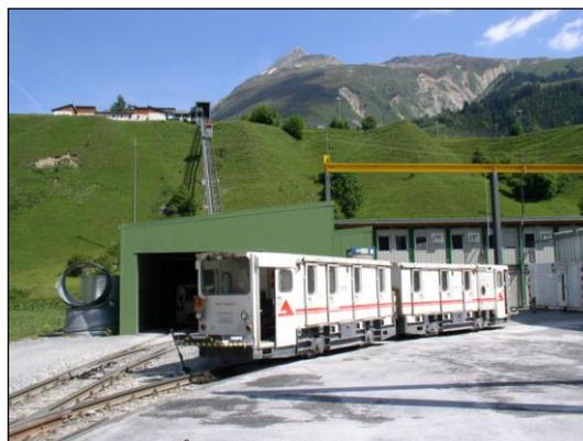
*Figura 26 – Cantiere AlpTransit (Sedrun) – Trenino su rotaia per il trasporto dei materiali da costruzione e del personale verso il fronte di scavo*
