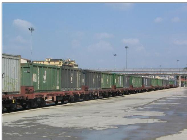
*Figura 18 – Nodo di Firenze – Trasporto dello smarino via ferrovia mediante carri pianale e container*
