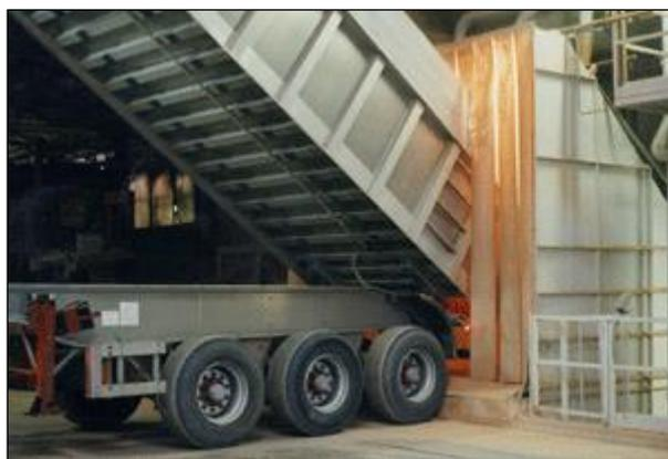
*Figura 25 – Esempio di tramoggia di scarico degli aggregati – da notarsi le protezioni per la riduzione della dispersione delle polveri*
