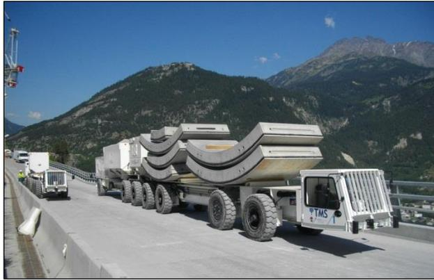
*Figura 27 – Cantiere Galleria di Sicurezza del Fréjus – Trenino su gomma per il trasporto dei materiali da costruzione verso il fronte di scavo*
