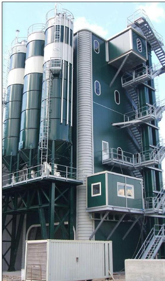
*Figura 3 – Impianto di betonaggio con silos verticali – Particolare della tipologia di schermatura contro rumore e polveri*
