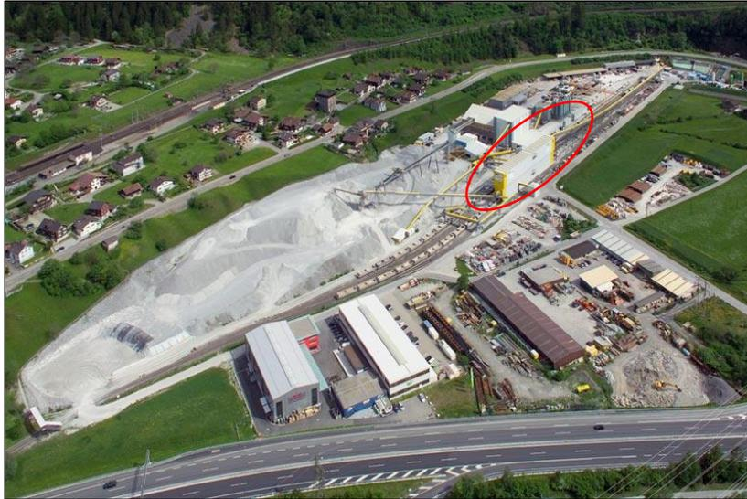
*Figura 19 – Cantiere AlpTransit (Amsteg) – Impianto di caricamento dei materiali di scavo su treno-
