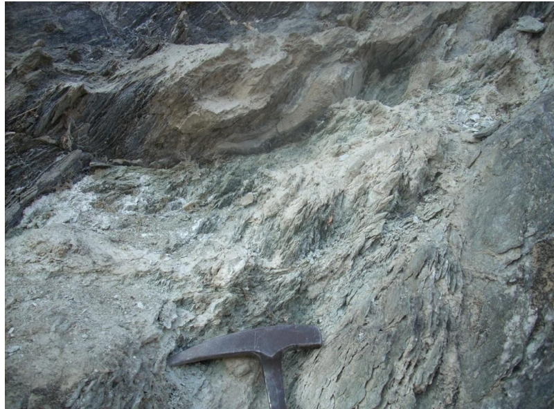
Figura 9 – Dettaglio della roccia in affioramento vicino al contatto tettonico tra calcemicascisti (in alto) e metabasiti (in basso) della Zona Piemontese – cf. rilievo strutturale SG048 (Allegato 2).
