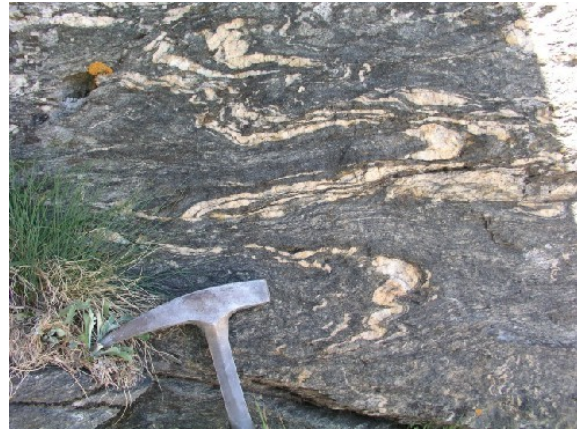
Photo 1-54 : Microplissement crénelé dans les micaschistes gris-bleu de la Clarea. Les fentes à quartz et feldspath sont typiques du socle.
