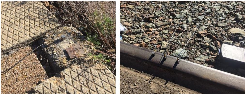
Figura 18 – Punti di installazione delle sonde accelerometriche nell'area della stazione ferroviaria
