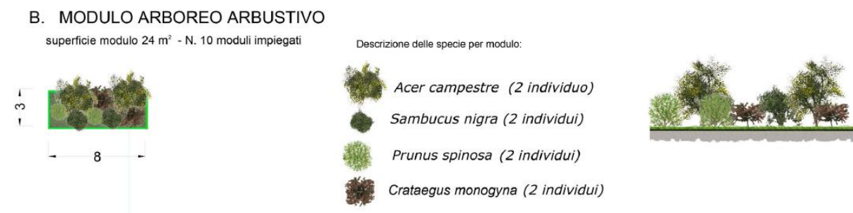
Figura 12 – Composizione e struttura della siepe mista prevista a nord del vallo paramassi (estratto PRV_TS3_C3C_7325: Album tipologico mitigazioni a verde delle aree oggetto di variante)
