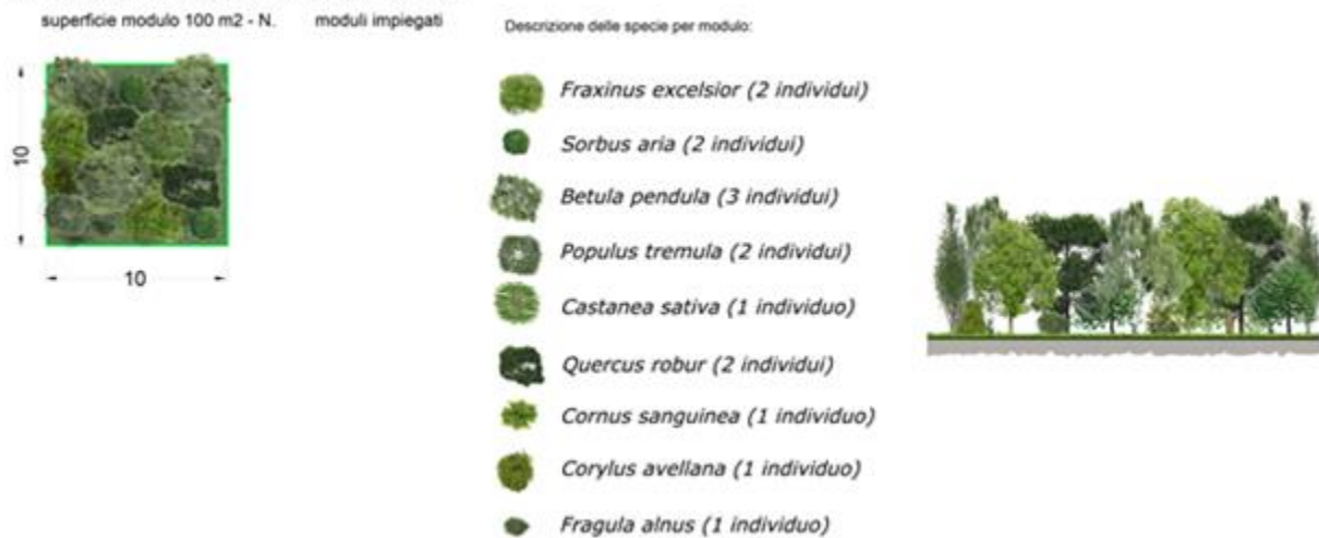
Figura 21 – Composizione e struttura del modulo misto arboreo-arbustivo previsto (estratto PRV_TS3_C3C_7325: Album tipologico mitigazioni a verde delle aree oggetto di variante)
