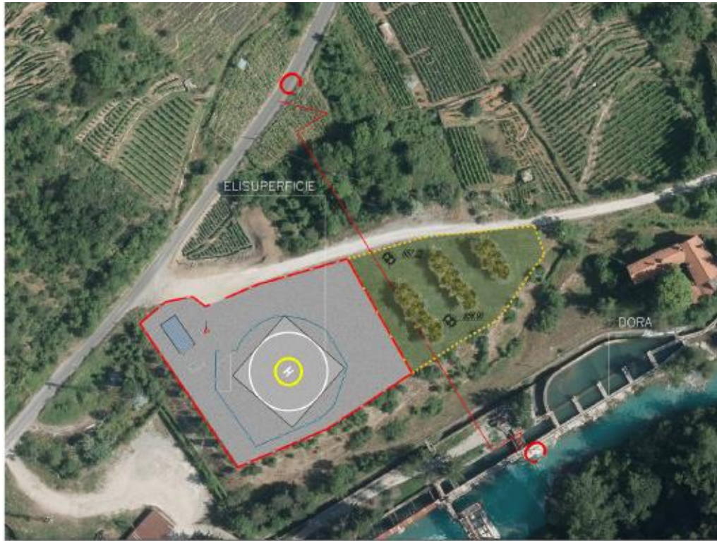
Figura 25 – Area di Colombera ripristinata (estratto PRV_TS3_C3C_0205: Interventi di ripristino cantiere di Maddalena e Colombera)
