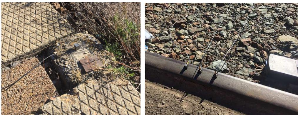
*Figura 7 – Punti di installazione delle sonde accelerometriche nell'area della stazione ferroviaria.*
