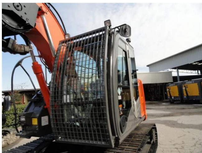
Protezione cabina di manovra
