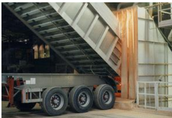
Esempio di tramoggia di scarico degli aggregati – da notarsi le protezioni per la riduzione della dispersione delle polveri
