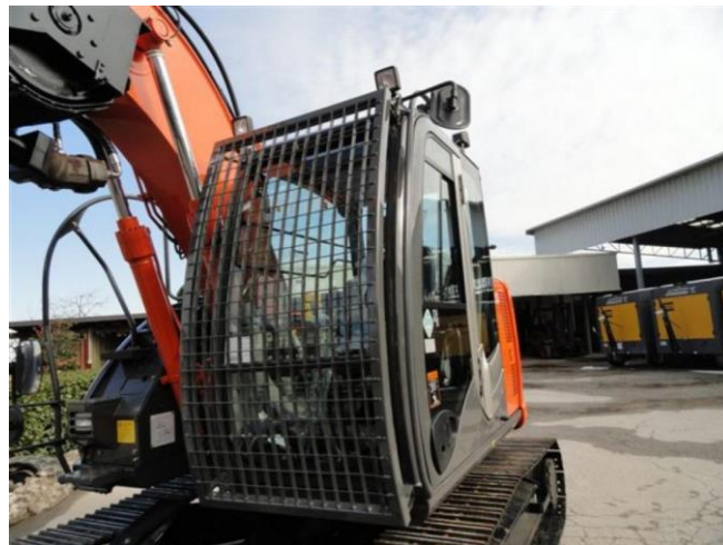
Protezione cabina di manovra
