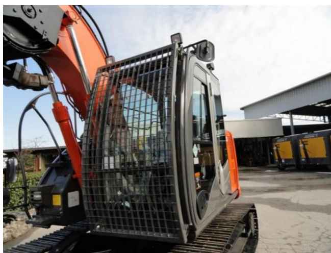
Protezione cabina di manovra
