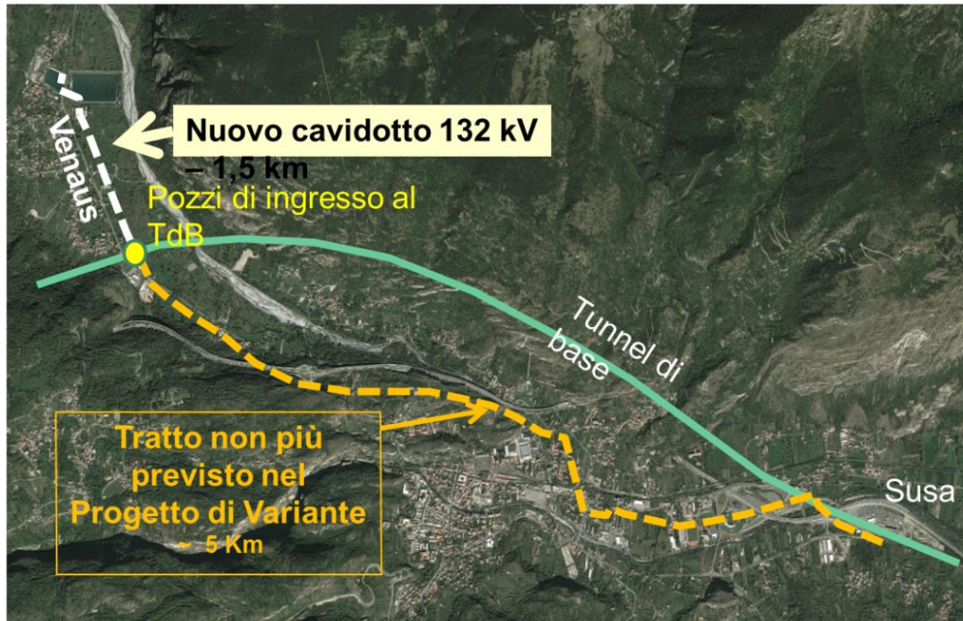
Figura 15 – Inquadramento territoriale del tracciato del nuovo cavidotto 132 kV rispetto al progetto definitivo approvato
