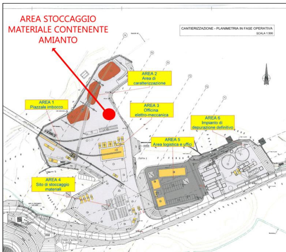
Figura 7-1 Area adibita allo stoccaggio dei sacchi di materiale contenente amianto.
