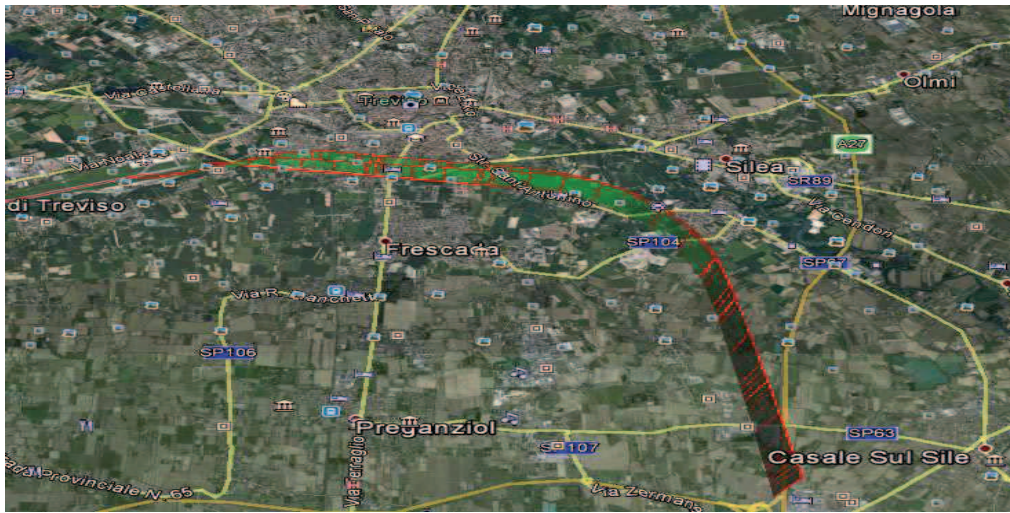
Traiettorie analizzate da ENAV nello "Studio progettuale relativo a procedure di salita iniziale per le piste 07 e 25 dell'Aeroporto di Treviso" per decolli da testata 07
