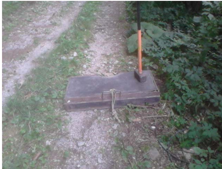
Abb. 5.2 – Platte zur Erzeugung der SH-Wellen
