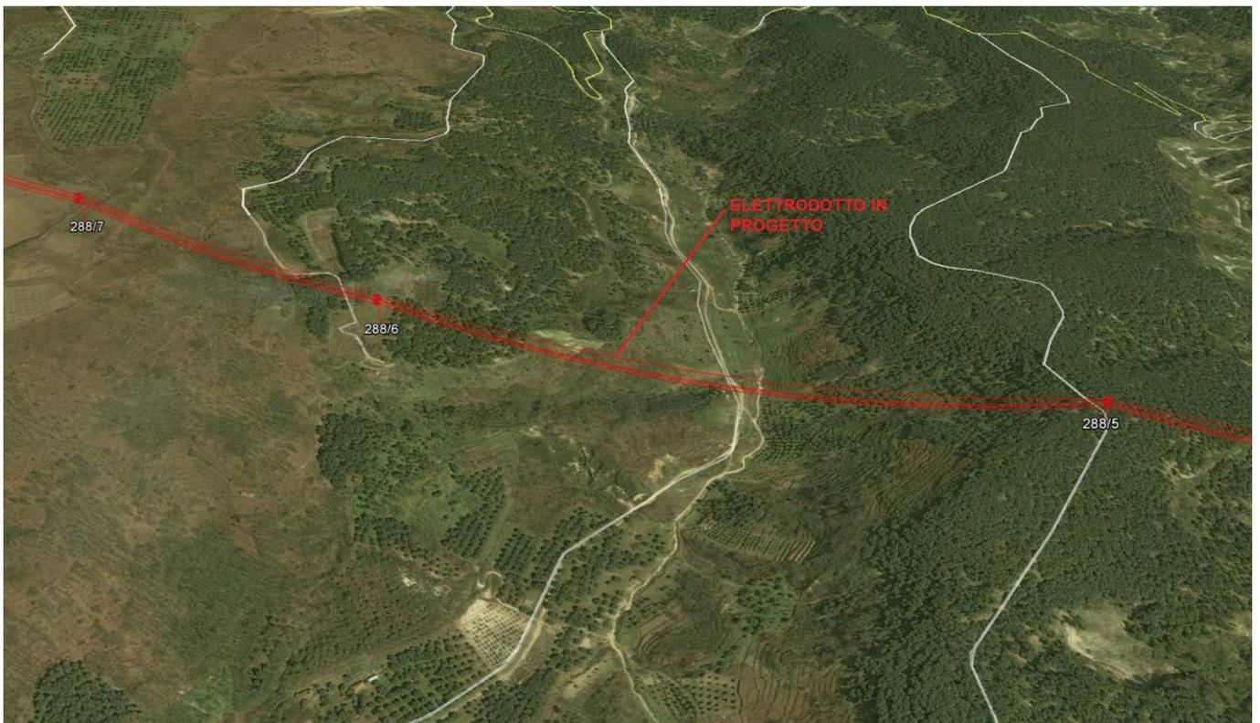
Il sostegno n° 288/10 sarà collocato in asse linea e prenderà in carico i conduttori dell'elettrodotto esistente da un lato mentre dall'altro permetterà il collegamento con la CP di S. Procopio.
