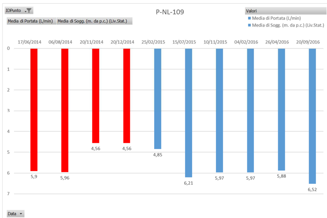
Figura 6.13 – Grafico riportante i dati della soggiacenza dei punti di misura appartenenti al gruppo di WBS GN1BC-CB-GA1L-COP7 (Monte) nel corso delle diverse campagne di misura realizzate (in rosso sono riportate le campagne realizzate in fase di Ante Operam e in azzurro quelle in Corso d’Opera).
