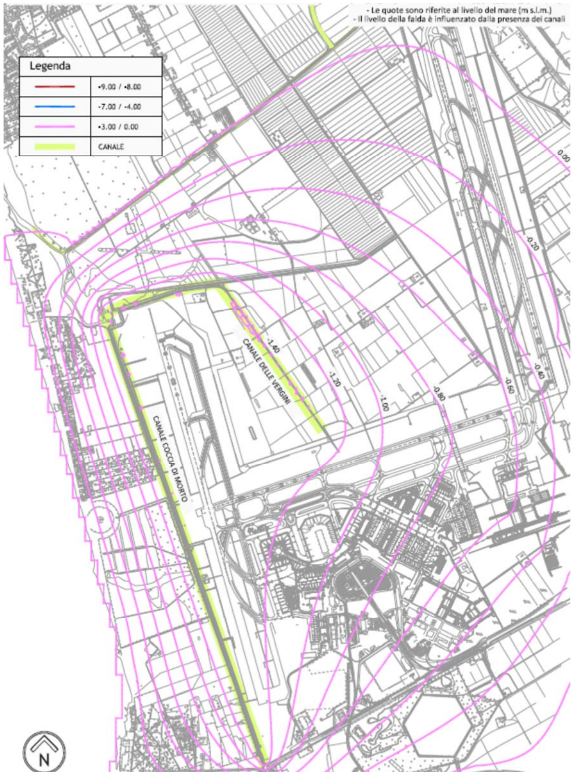
Figura 3-1 Modellazione della superficie freatica in condizioni indisturbate
