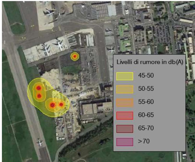
Figura 7-16 Curve di isolivello acustico cantiere nel periodo notturno
