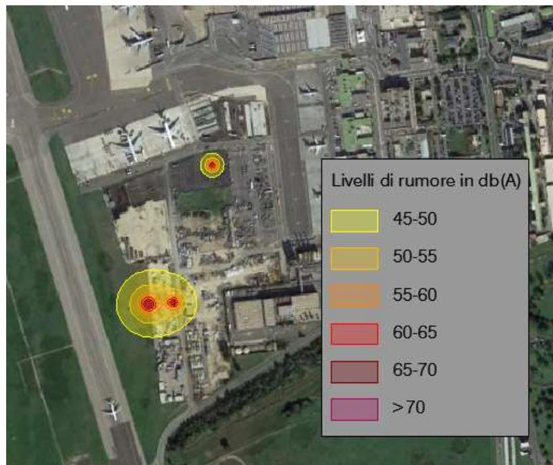
Figura 7-15 Curve di isolivello acustico cantiere nel periodo diurno
