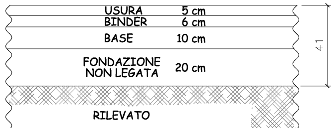
Figura - Sovrastruttura viabilità di servizio
