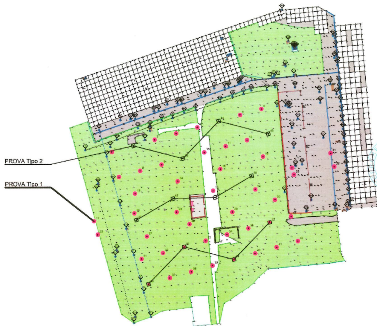
Figura 5 - Ubicazione prove portanza terreni di sottofondo
