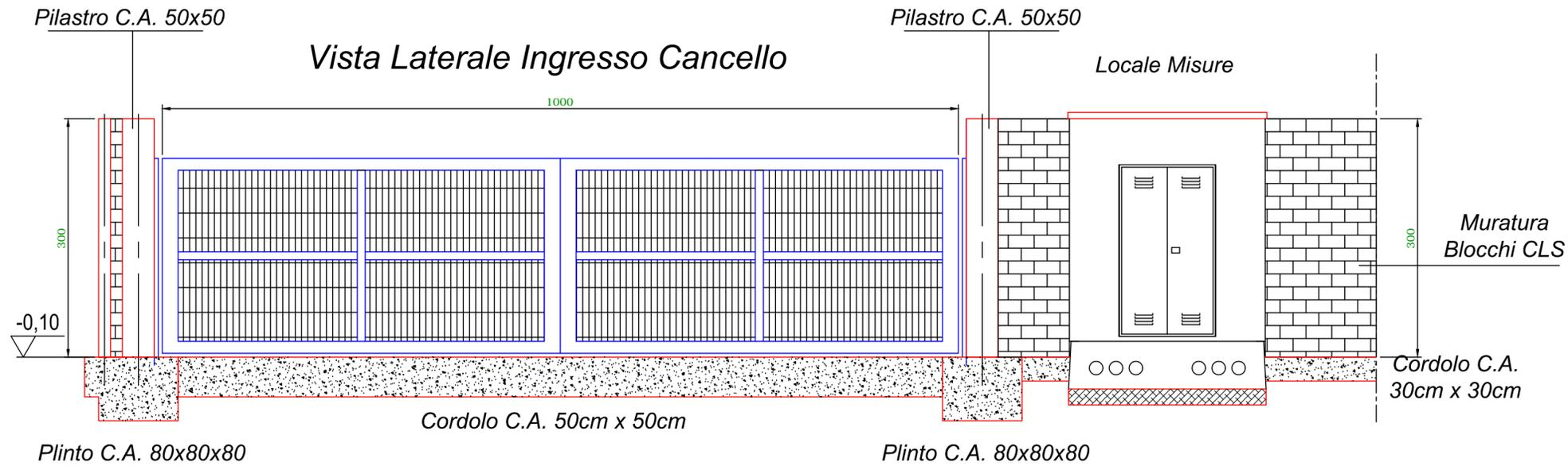
Cannello realizzato con profili di acciaio zincato e rete grigliata elettro-saldata
