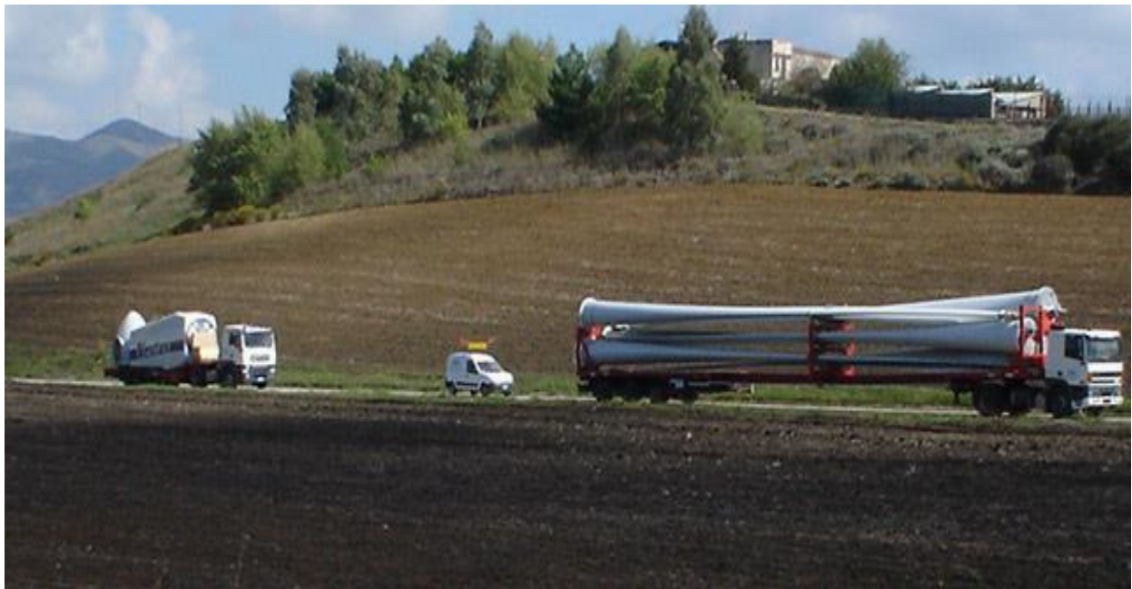
Trailer di 26 m per il trasporto delle pale di un aerogeneratore di media taglia
