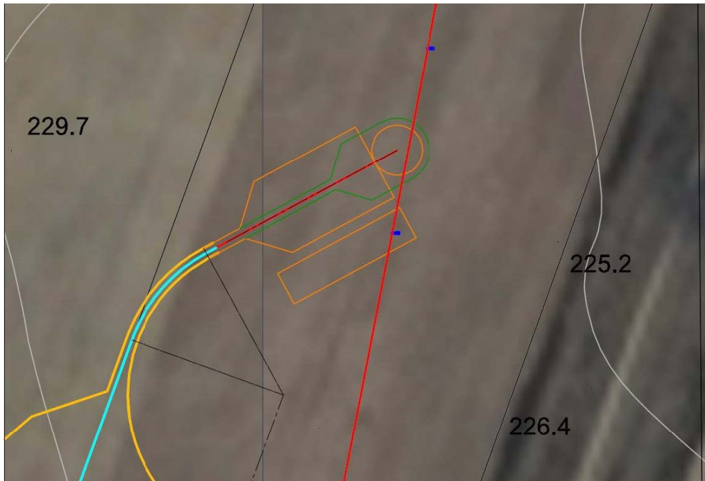
Interferenza di una Linea MT esistente con la piazzola di Cantiere e Definitiva della WTG 12
