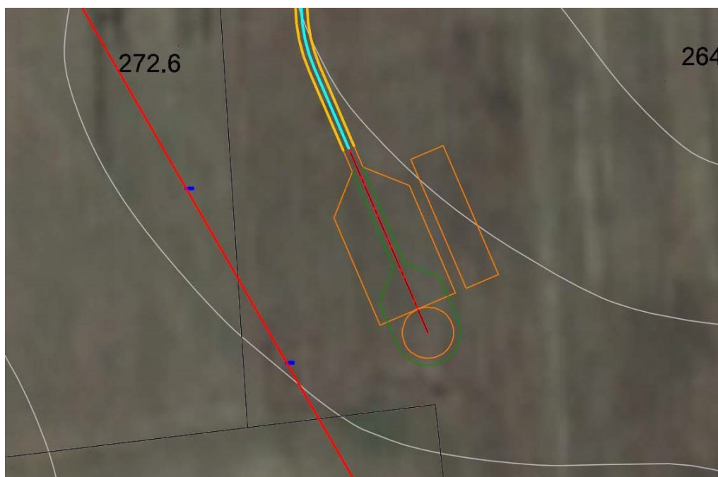
Interferenza di una Linea MT esistente con l'area di installazione della WTG 9
