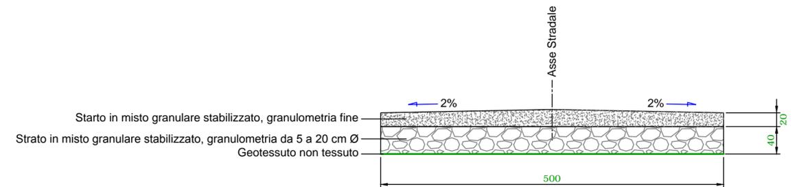
SEZIONE TIPICA IN RILEVATO
