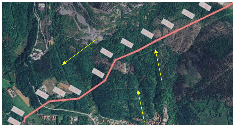
Figura 59: stralcio su foto aerea con i visibili varchi nella componente boscata delle linee esistenti
