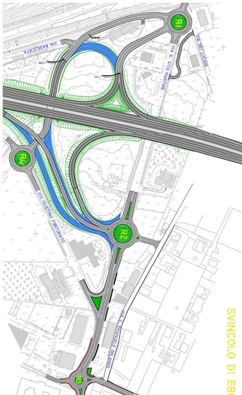
3: Schema planimetrico di modifica dello svincolo (in blu le dismissioni)
