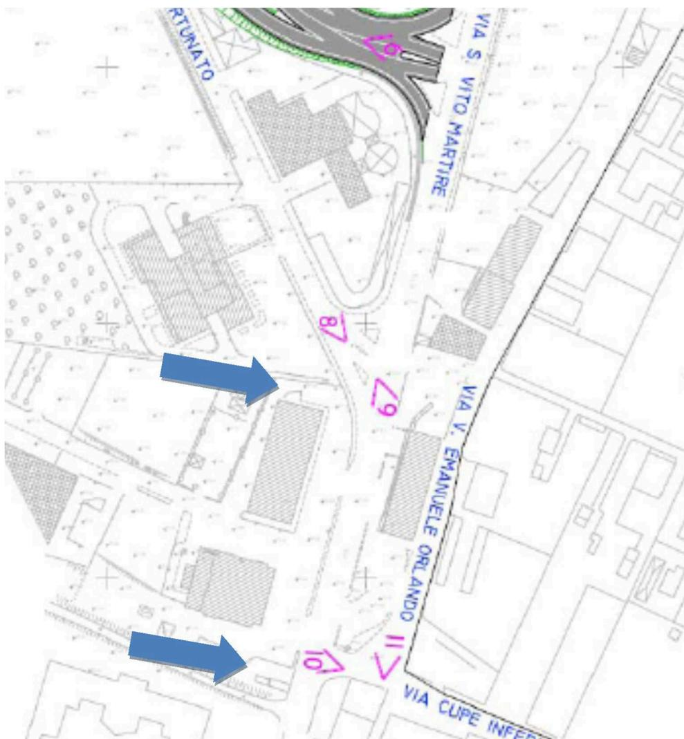
Nella figura che precede si vede l'intersezione fra la SP 30 (via S. Vito Martire) e la SP 195 (via G. Fortunato) indicata dalla freccia. L'assetto attuale permette anche le svolte in sinistra. Più in basso l'intersezione con via Cupe inferiore dove si dovrebbe realizzare la rotonda R3.
