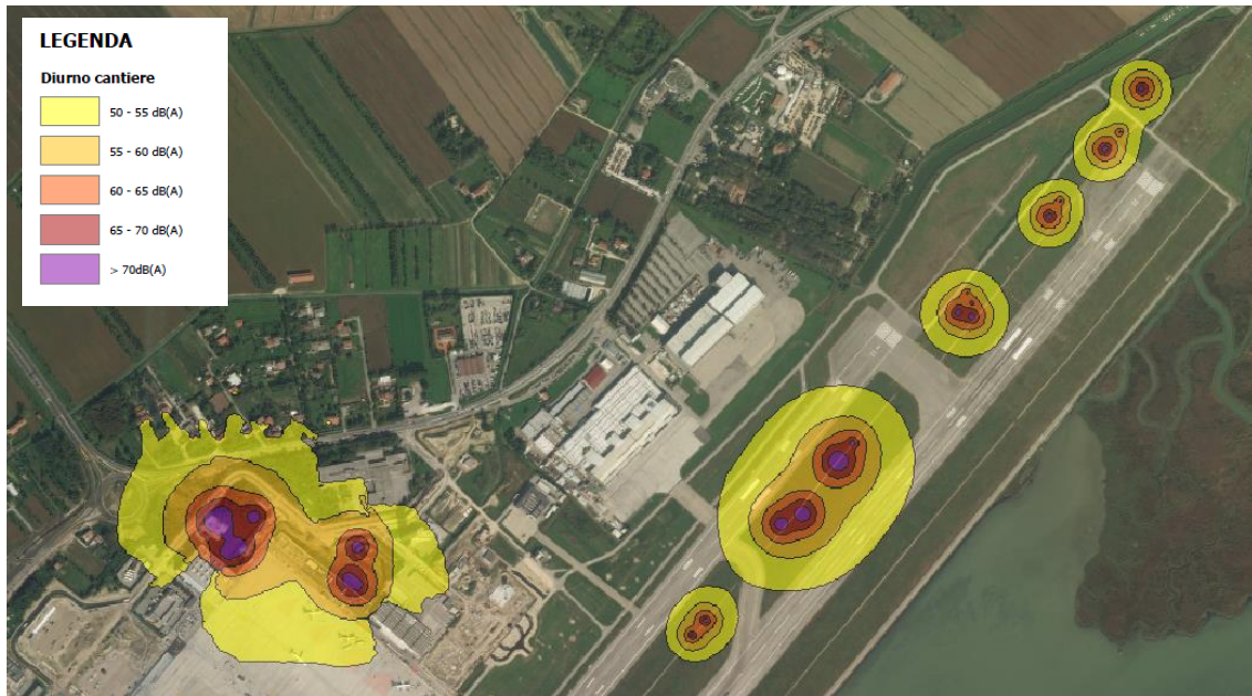
Figura 10-18 Particolare delle curve di isolivello acustico cantiere (parte nord) nel periodo diurno
