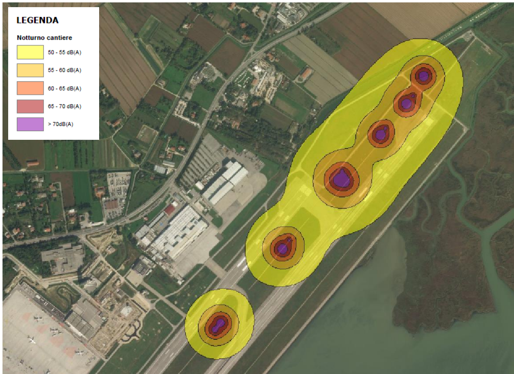
Figura 10-21 Particolare delle curve di isolivello acustico cantiere (parte nord) nel periodo notturno
