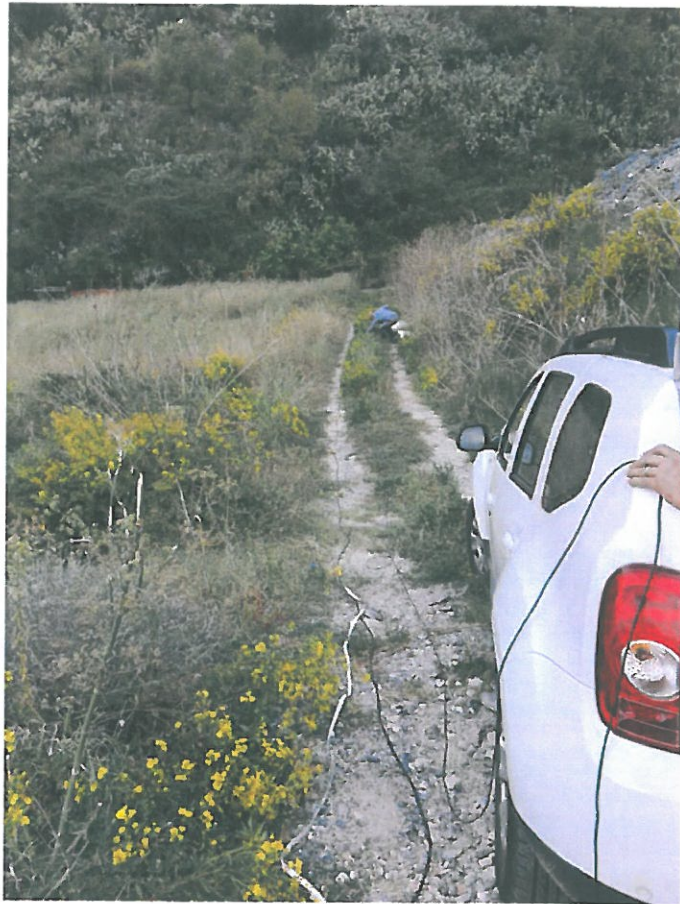
Foto 1. Prospezione sismica a rifrazione onde P
