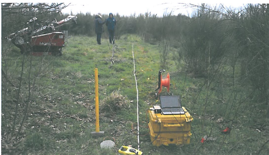
Vista Ubicazione BASE SISMICA MASW CONDOTTA SORICAL 1
